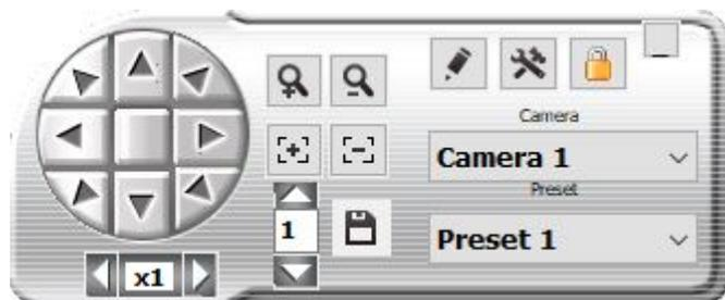
È inoltre possibile l'**intervento manuale** dell'operatore per la selezione di un'inquadratura differente da quella automatica, sia da *NexusPub* Meeting Manager che da *NexusPub* Video Controller; è inoltre possibile modificare parametri come posizione e zoom di un'inquadratura grazie alla ghiera direzionale e ai pulsanti dedicati dell'interfaccia
